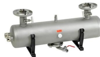
La technologie UVC (traitement par Ultra-violet) a pour principe de générer des rayons ultraviolets au sein d'une chambre de traitement. Ces rayons irradient les cellules vivantes contenues dans le fluide traversant le stérilisateur, sans modifier les critères physico-chimiques et sans générer de polluants résiduels.
